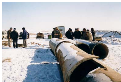
شکل شماره ۱۳- ترکیدگی لوله در هنگام تست هیدرواستاتیک
