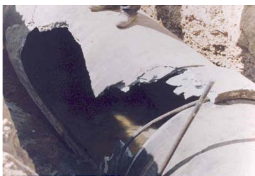
شکل شماره ۱۴- ترکیدگی لوله در هنگام تست هیدرواستاتیک
