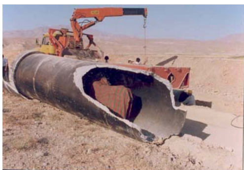
شکل شماره ۱۲- ترکیدگی لوله در هنگام تست هیدرواستاتیک
