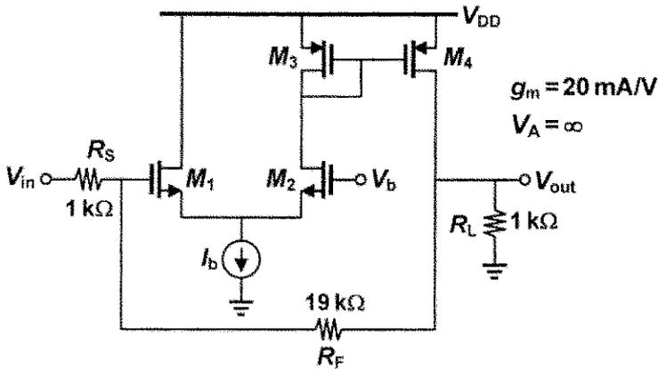
ولتاژ  $A_v = \frac{V_{out}}{V_{in}}$  تقریباً کدام است؟
