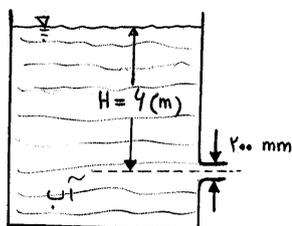
۲. الف. سرعت شارش را از شیپوره واقع در دیواره مخزن شکل زیر تعیین کنید:
