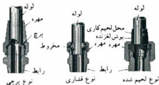
شکل ۱۰ - انواع اتصالات لوله بنزین
