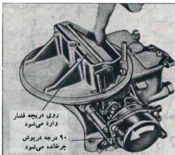
شکل ۳۶ - اندازه گیری کفش دریچه ساسات
