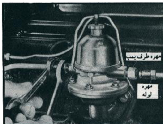
شکل ۱۳ - رابط مضاعف در اتصال لوله پمپ بنزین
