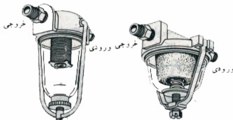
شکل ۱۸ - دو نوع فیلتر سوخت
