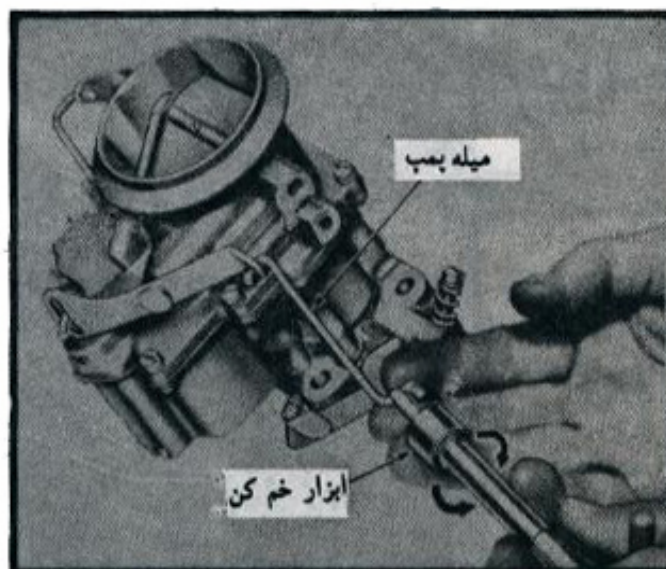
شکل ۴۲ - خم کردن اهرم پمپ شتاب دهنده
