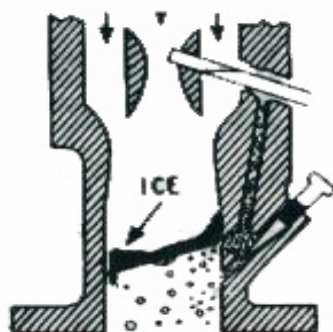
شکل ۵ - یخ زدن دریچه گاز
