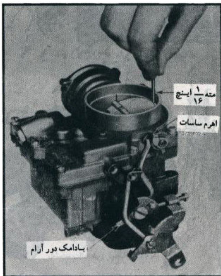
شکل ۳۷ - تنظیم دور آرام حالت ساسات
