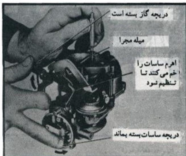
شکل ۳۱ - تنظیم دور آرام در حالت استفاده از مدار ساسات
