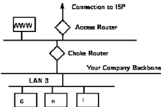
در چنین سیستم‌هایی ، اتصالات جدید باید در لایه کاربردی تایید و به تصویب برسند. زمانی که این اتفاق افتاد ، بقیه اتصال به لایه *session* فرستاده می‌شود ، که در آن برای فیلترهای بسته اتصال را کنترل می‌کند تا مطمئن شوند که تنها بسته هایی که بخشی از یک حاوره در حال پیشرفت ( که همچنین مجاز و مورد تایید هستند ) عبور می‌کنند.
