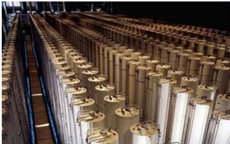
شکل (۳-۱۷): شمایی از زنجیره آبشاری طبقه‌های چرخان در روش سانتریفوژ گازی
