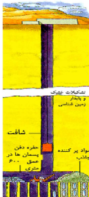
شکل (۵-۷): نمای شماتیک از مراحل دفن پسمان‌های رادیواکتیو در اعماق بیش از ۳۰۰ متر
