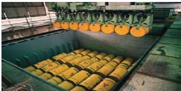
شکل (۵-۱۰): عملیات آماده سازی زباله های اتمی برای انبار کردن در کشور ژاپن
