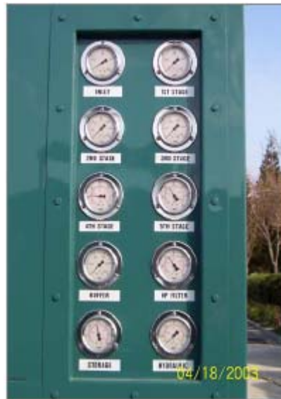
شکل ۸-۱ ابزارهای اندازه گیری فشار و دمای گاز کمپرسور
