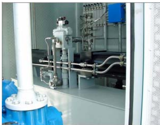
شکل ۱۰-۱ کمپرسور تقویت کننده چهار و پنج مرحله ای
